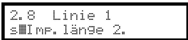
Mit den Zifferntasten "0" bis "9" die Impulslänge eingeben (ein schwarzes Feld blinkt während der Eingabe über der Zahl). Der maximale Wert der Impulslänge beträgt 9,9 Sekunden. Mit Taste "edit" bestätigen.
