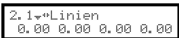
Hier werden pro Linie die gemessenen Stromwerte in Ampere (A) angezeigt.
