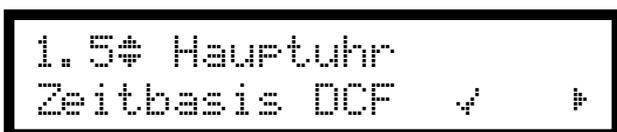
Durch ein **Häkchen** wird hier angezeigt, dass sich die Hauptuhr innerhalb der letzten 24 Stunden auf den DCF77- oder GPS-Funkempfänger synchronisiert hat.
