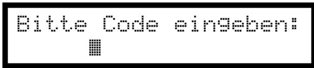
Geben Sie den Code mit den Zifferntasten "0" bis "9" ein und bestätigen Sie mit "edit". Die Tastatur ist freigeschaltet.
