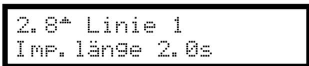
Wählen Sie die gewünschte Linie mit den Zifferntasten "1" bis "4" aus. Die angezeigte Impulslänge mit der Taste "edit" bestätigen.
