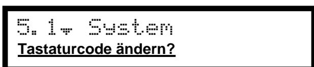
Im Menü 5.2 besteht die Möglichkeit, den Tastatur-Code zu **ändern**. Im Auslieferungszustand lautet der Code 0000, die Tastatur ist nicht verriegelt. (Abbruch mit der Taste "menue"). Möchten Sie einen Code eingeben oder ändern, drücken Sie "edit".
