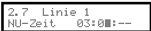
Mit den Zifferntasten "0" bis "9" geben Sie jetzt die **manuell eingestellte**, einheitliche (!) Uhrzeit der Nebenuhren dieser Linie ein. Bei Erstinbetriebnahme z.B. 12:00:--, bei vorhandener, jedoch angehaltener Nebenuhrenanlage die Uhrzeit, die die (montierten) Nebenuhren z.Zt. anzeigen. Mit "edit" bestätigen.
