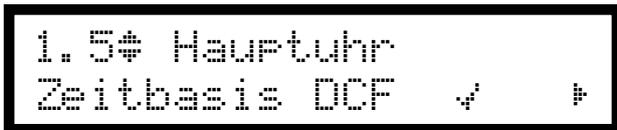
Durch ein **Häkchen** wird hier angezeigt, dass sich die Hauptuhr innerhalb der letzten 24 Stunden **erfolgreich** auf den DCF77- oder GPS-Funkempfänger synchronisiert hat.
