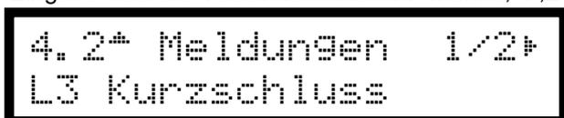
Die Meldungen werden mit den Pfeiltasten ◀▶ durchgeblättert und mit der Taste "edit" **gelöscht**, nicht behoben. Steht der Fehler-Zähler wieder auf [0], erlischt der rote Alarm-LED, der Alarmkontakt wird ausgeschaltet. (In nebenstehendem Beispiel wird 1 von insgesamt 2 gespeicherten Fehlermeldungen angezeigt: Kurzschluss auf Linie 3).
