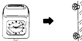
6. die Uhr wieder einhängen und den Winkel mit der dritten Schraube fixieren.
