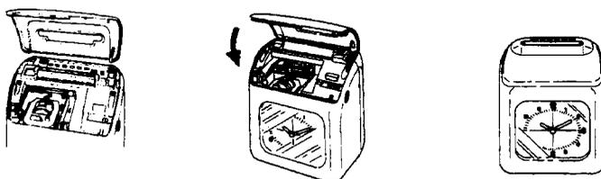
1. Die Nasen des Deckels in die Öffnungen setzen.
